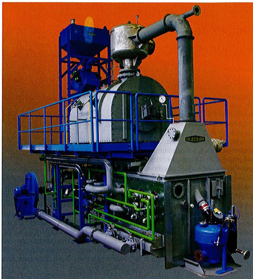
Bild 1: Kompakte thermische Regenerierung, vor der Auslieferung an den Kunden im Werk aufgebaut.
