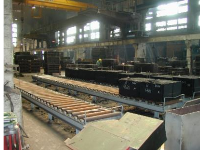
Bild 5: Gieß- und Kühlstrecke
